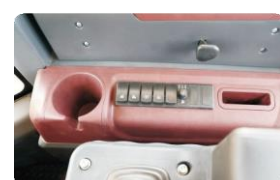
Wyposażony w przełączniki polimorficzne, trzystopniowy tryb zasilania ma znaczący wpływ na redukcję kosztów i zmniejszenie zużycia.
